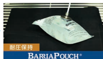
バリアパウチでは水漏れは 発生しませんでした。
