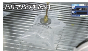
圧力試験写真(AT.-40℃ 95kPa)
